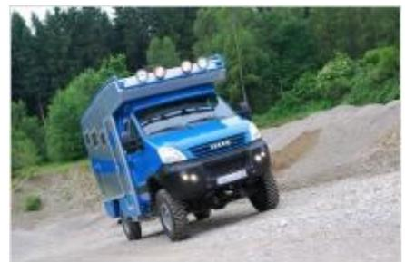
Fahrgestell wird der Originalrahmen durch einen Hilfsrahmen stabilisiert. Auf dem Hilfsrahmen ist die Wohnkabine mit sechs Elastic-Lagerungen beweglich befestigt.
