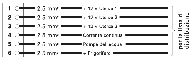
Figura 12: Schema dei collegamenti connettore a spina a 6 poli
